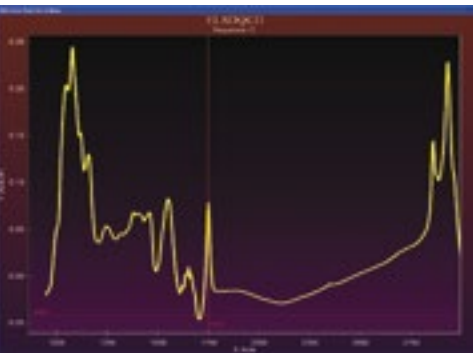
Das komplette FTIR-Absorptionsspektrum der Milchprobe wird zur Auswertung herangezogen. Modernste Algorithmen berechnen daraus die Zusammensetzung. Die Spektren werden laufend gespeichert und können später jederzeit wiederverwendet, analysiert und ausgewertet werden.
